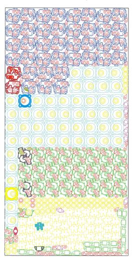
AutoNEST hilft bei der Verschnittoptimierung von Rohmaterialien wie Blech, Verpackungsmaterial oder Stoffen. Auch ungleiche Formen können verschachtelt werden.
